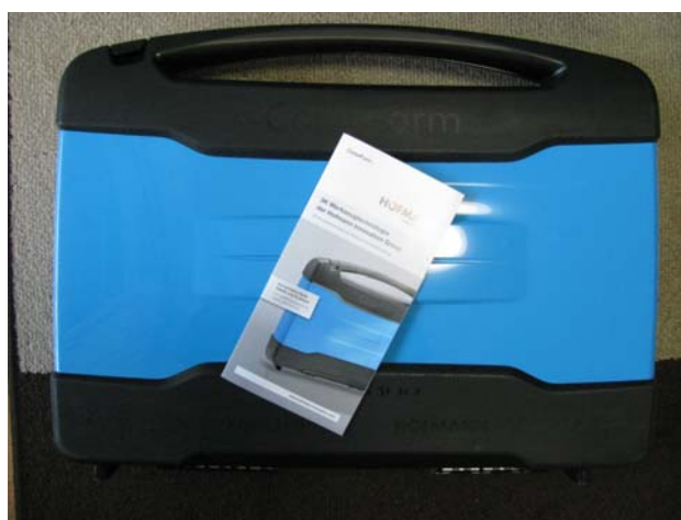
図6 KraussMaffei のブースで成形実演していた アタッシュケース ABS 樹脂/TPU/ウレタン塗料の3ショットから成る
