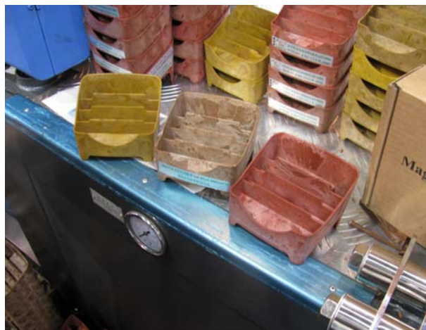
図20 シンガポール Chuan Durn Plastic Industries による木粉/HDPE コンポジットを用いた射出成形品
