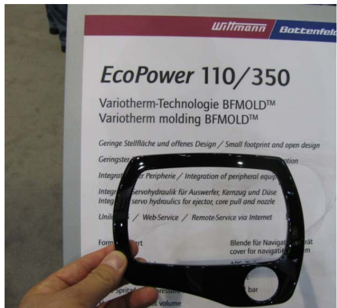
図2 BF モールドによるウェルドレス高光沢成形品
