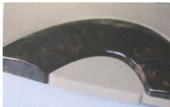
図5 ENGEL のブースで成形実演されていた 「つき板」インサート成形品
