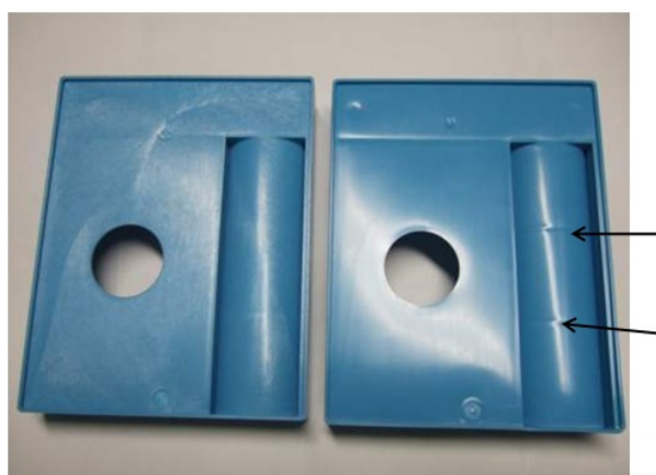
図6. ポリプロピレン成形品のヒケの様子 左：微細射出発泡成形 (MuCell)、右：通常射出成形 (東芝機械殿提供)
