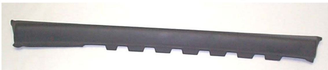
図13 MuCell 成形(PVC 表皮付き)によるドアトリムアッパー(参考文献 3 掲載の写真)
