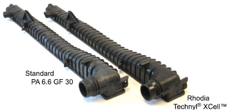
図11 一般ナイロンと MuCell 専用銘柄の表面状態の比較
